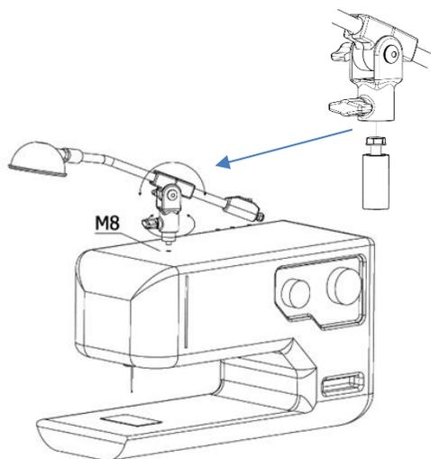
Svitando i due volantini dello snodo di è possibile regolare la posizione della lampada. Una volta definita, fissare nuovamente.
