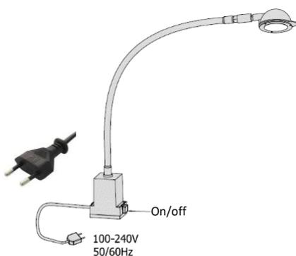
La lampada è fornita di un interruttore on-off sulla base che interrompe il primario del driver LED interno alla lampada (alimentazione 230 V).
