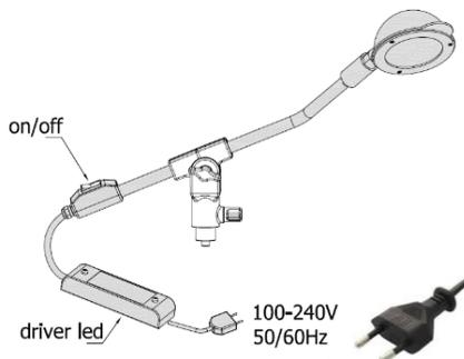
La lampada è fornita di un interruttore sullo stelo rigido che interrompe il secondario del driver LED esterno alla lampada.
